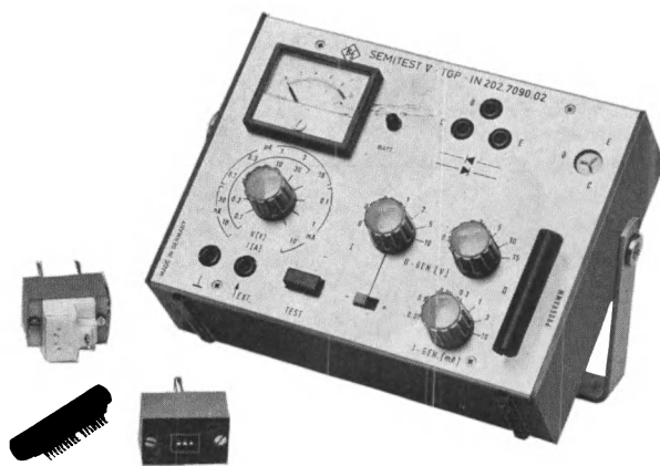
Испытатель типа TGP с двумя адаптерами и программирующим штеккером.
